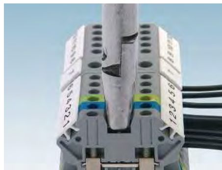
Dedo de prueba con diámetro de 12,5 mm
