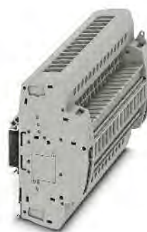
Regleta de clavijas de prueba 10 (10) mm 2 , 30 A, 4 ... 25 polos, para montaje sobre carril, conexión por tornillo
