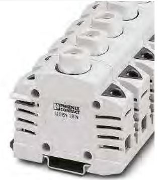
35 (35) mm 2 , 63 A, borne para fusible para NEOZED D 02 (E18)
