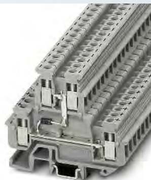
2,5 (4) mm 2 , 24 A, borne de doble piso, con diodo incorporado 1N 4007
