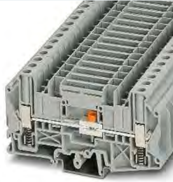
10 (10) mm 2 , 50 A, borne seccionable de transductor de medida
