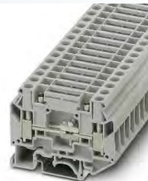
6 (10) mm 2 , 57 A, borne seccionable, con conectores hembra de pruebas
