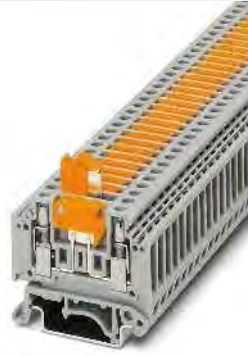
2,5 (4) mm 2 , 16 A, borne interrumpible por cuchilla con hembras roscadas para tomas de prueba
