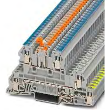
4 (4) mm 2 , 24 A, borne de tres pisos, 1 cable exterior L, 1 conductor N seccionable, 1 PE
