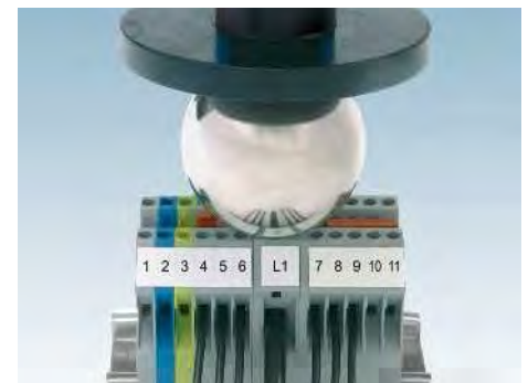
Dedo de prueba con diámetro de 50 mm
