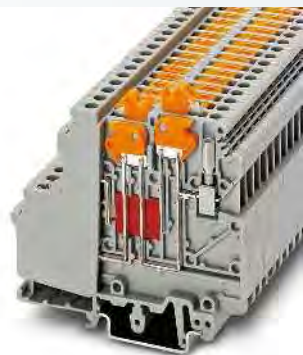
4 (4) mm 2 , 8 A, borne de paso, 3 conexiones con 2 cuchillas de interrupción hembras roscadas para tomas de prueba
