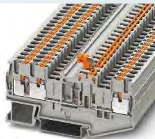
16 A, borne interrumpible por cuchilla, 3 conexiones, 4 fosos funcionales
