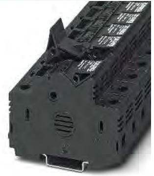
16 (25) mm 2 , 32 A, borne para fusible por palanca para fusibles Midget 10,3 x 38 mm
