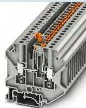
4 (6) mm 2 , 20 A, borne interrumpible por cuchilla, 2 conexiones
