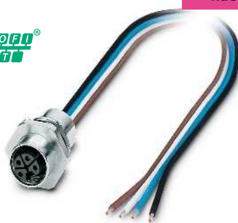
Con codificación L, sección de cable: 2,5 mm 2 , 4 polos
