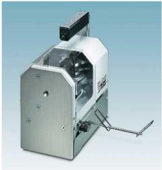
El pelador y engarzador automático CF 3000-2,5 procesa punteras en ejecución por metros con collar aislante según DIN 46228-4 y UL 486F. Este equipo permite pelar conductores de sección 0,25 -2,5 mm² en una sola operación y confeccio-
