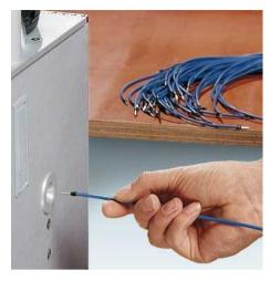
El engarzador y pelacables automáticos procesan punteras sueltas de 0,25 a 4 mm² con collar aislante según DIN 46228-4/UL 486F.
