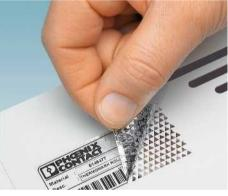
Las etiquetas seguras frente a manipulación se usan como placas de tipo o etiquetas de precinto. Al quitarlo se separa una parte de la capa metalizada. Esta parte deja una marca en la etiqueta y en el suelo.
