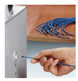
El engarzador y pelacables automáticos procesan punteras sueltas de 0,25 a 4 mm<sup>2</sup> con collar aislante según DIN 46228-4/UL 486F.
