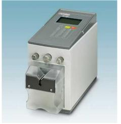
El pelacables automático WF 1000 permite el pelado automático de conductores hasta 6 mm² o de cables hasta 6 mm de diámetro. Asimismo, es posible una retirada parcial del aislamiento.
