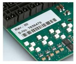
Las etiquetas para altas temperaturas son excelentes para identificar placas de circuito impreso. Las etiquetas soportan de forma permanente y segura temperaturas de -40 °C a 180 °C; 300 °C hasta 60 s.
