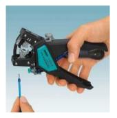
Pinzas de crimpado multifuncional para cortar, pelar, trenzar y engarzar punteras CRIMPFOX 4 IN 1... Pág. 415
