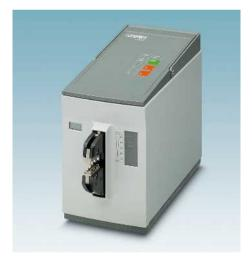
La máquina de crimpado CF 500 se caracteriza por su gran fuerza de crimpado con un diseño compacto y su elevada flexibilidad. Gracias a las matrices intercambiables es adecuado, entre otras cosas, para terminales de cable aislados, en tubo y de apriete, manguitos de enchufe plano y punteras de hasta 50 mm<sup>2</sup>.
