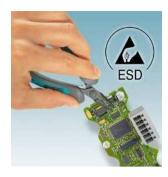
Pinzas electrónicas, de corte, para sujetar y torcer
