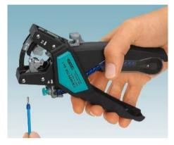
El CRIMPFOX 4 IN 1 es una pinza de crimpado multifuncional para procesar conductores y punteras. Con solo una herramienta pueden llevarse a cabo distintos pasos de trabajo: cortar, pelar, trenzar y engarzar.
