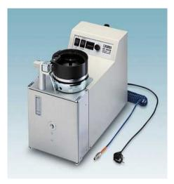
El pelador y engarzador automático CF 1000 procesa punteras sueltas (a granel) con collar aislante según DIN 46228-4 y UL 486F. Con esta máquina automática se pueden pelar conductores en una sola operación y confeccionarse con punteras.
