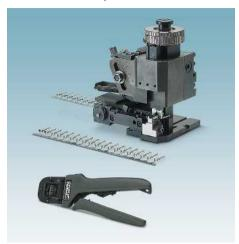
Las secuencias de movimiento paralelas de las matrices producen resultados de crimpado simétricos y óptimos
