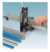
Cortador de canaletas de cableado PPS CD M Pág. 399
