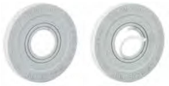
Los aros circulares individuales se van eliminando en función del diámetro del cable o tubo. Para ello sólo es necesario hacer un agujero en el contorno del aro a eliminar, el resto sale fácilmente.
