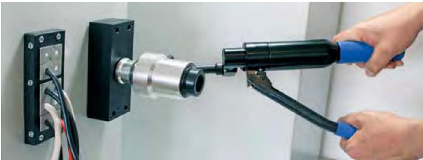
icotek ofrece punzonadoras hidráulicas manuales para trabajar sobre acero V2A, chapa de acero, aluminio y plástico. Su cabezal giratorio a 360° (en 3 ejes) facilitan y hacen cómoda la tarea de realizar orificios en la chapa incluso en las ubicaciones menos accesibles.
