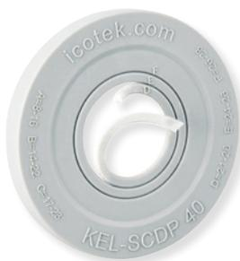
Los aros circulares individuales se van eliminando en función del diámetro del cable o tubo. Para ello sólo es necesario hacer un agujero en el contorno del aro a eliminar, el resto sale fácilmente.
