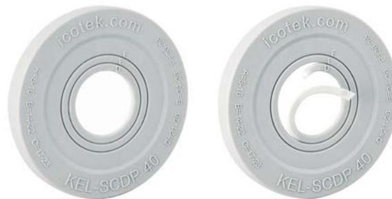
Los aros circulares individuales se van eliminando en función del diámetro del cable o tubo. Para ello sólo es necesario hacer un agujero en el contorno del aro a eliminar, el resto sale fácilmente.
