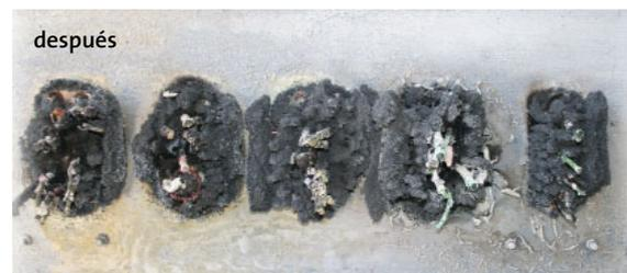
Los pasacables de icotek han sido testeados según la norma EN 45545-3 y EN 1363-1 tanto en los niveles "E" como en los niveles "EI", para situaciones con montaje vertical y uso de las juntas intumescentes IFPS que actúan como barrera ante la propagación de la llama y humo. Todos los productos ensayados han sido certificados con éxito usando tan sólo una capa de juntas intumescentes.
