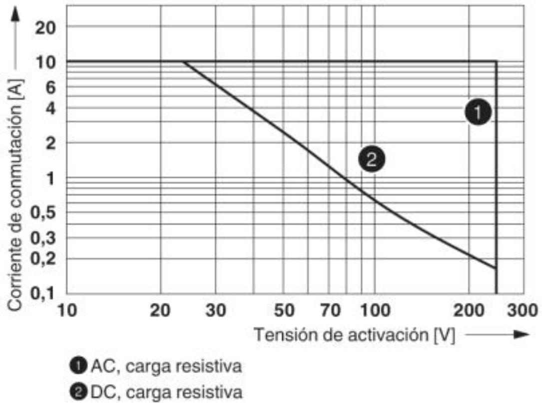
Potencia de ruptura
