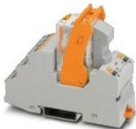
Módulo de relé premontado con conexión push-in, compuesto de: zócalo de relé, relé con contacto de potencia, módulo de indicación/antiparasitario enchufable y brida de sujeción. Tipo de contacto: 2 contactos inversores. Tensión de entrada: 24 V AC
